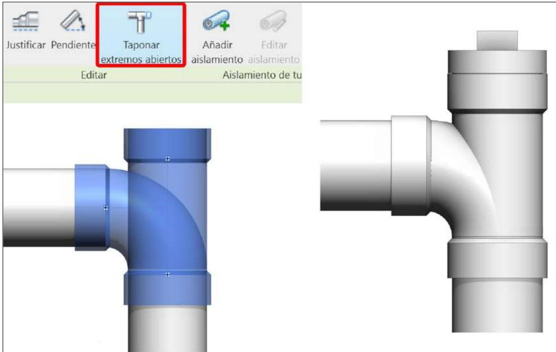
En caso de hacer los mismos pasos en el extremo de un tubo que este definido como espiga, el Adaptador de Limpieza no puede ser utilizado, teniendo que ser cambiado por un tapón como se muestra a continuación:
