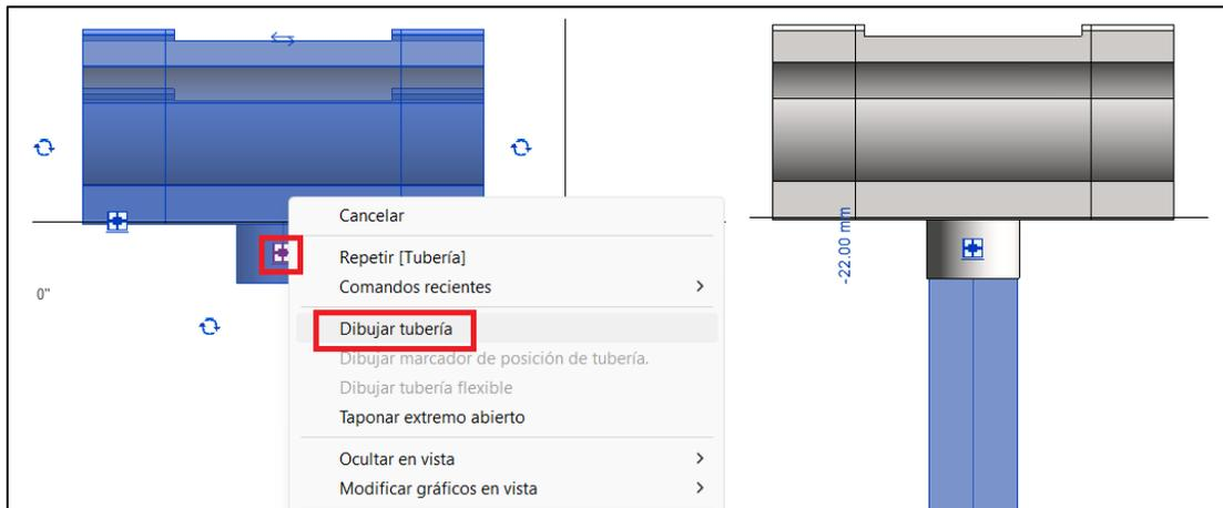
Si no se encuentra alineado desde la vista en planta, selecciona la tubería y muévela al punto de conexión de la bajante
