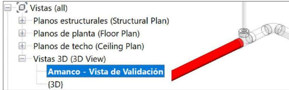
b) Divida la tubería en secciones usando el comando *Dividir Elemento* (SL en el teclado), clic en alguna parte de la tubería y ubique la campana/unión que aparece de acuerdo a la máxima longitud disponible.
